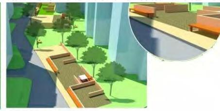
\*成本估算: 若墙体材料选择毛石, 因毛石单价为 200 元/平方米, 人工费为 100 元/平方米, 本案中墙体总面积约 250 平方米, 故筑墙总成本约 7.5 万元。
